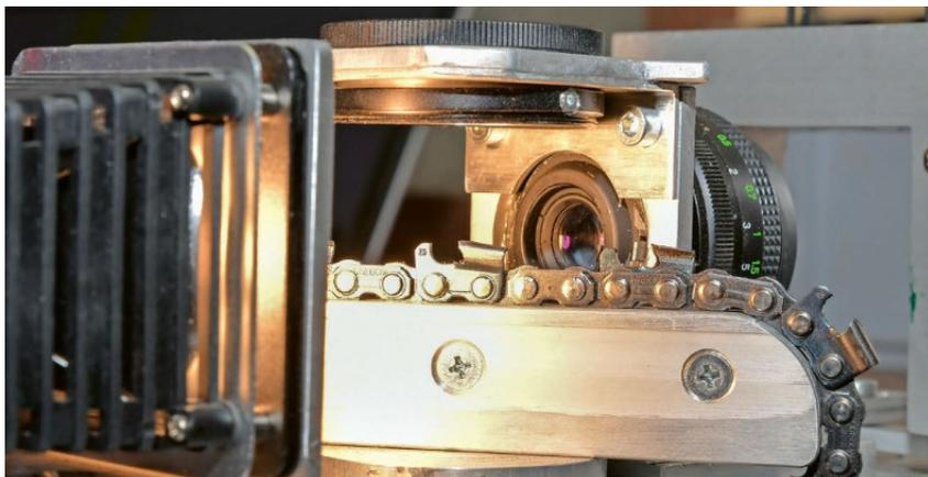
Instrument zur optischen Kontrolle von Brust-, Schneid- und Dachwinkel Stefphan Isler
